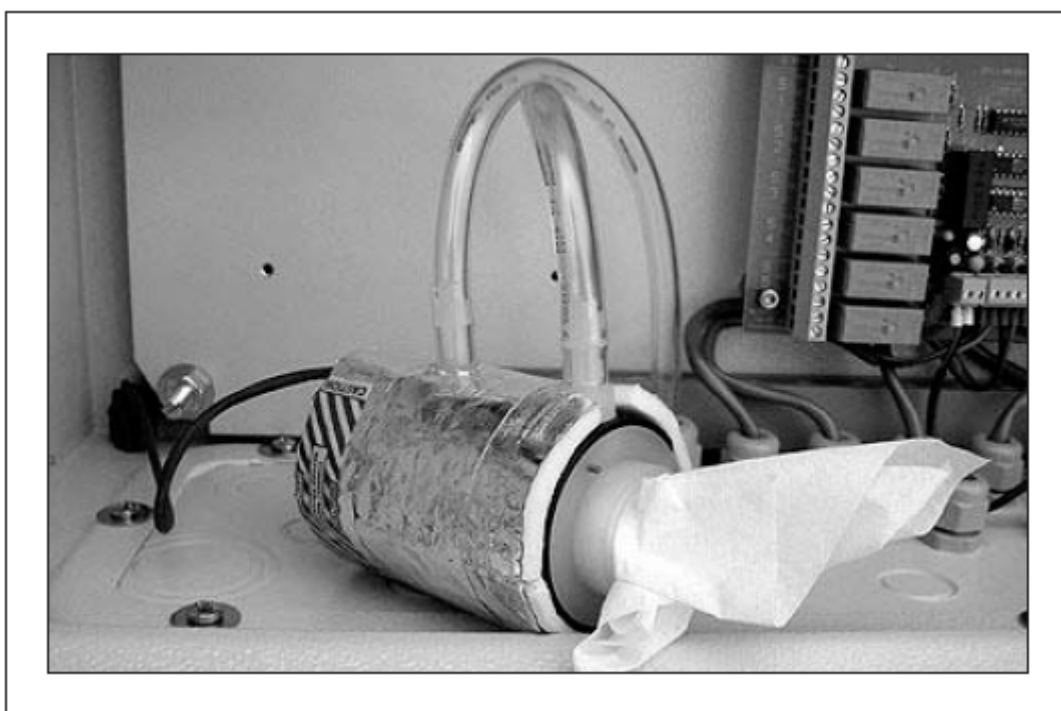
图 7-52 清洗 IR 室组件的内壁
